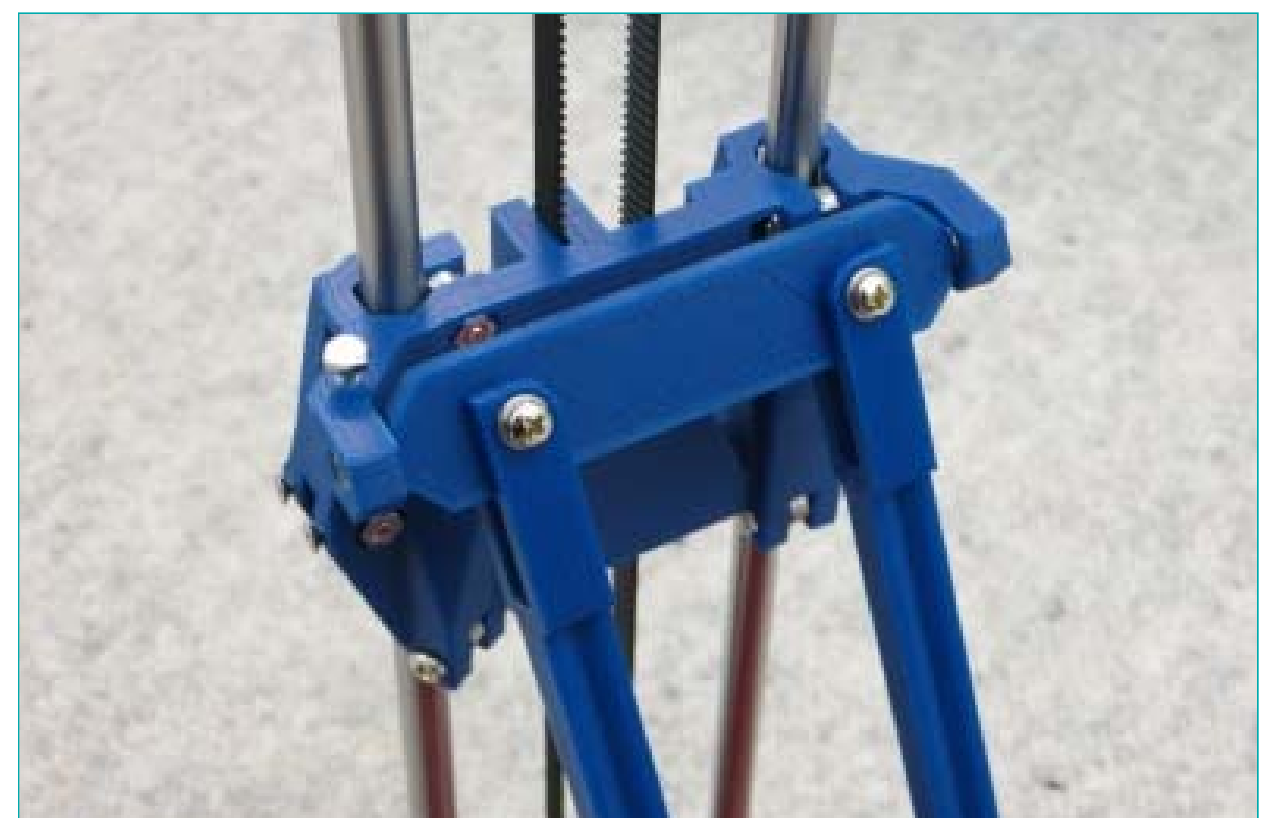
Teilansicht: kugelgelagerte Diagonalstreben (rods)
