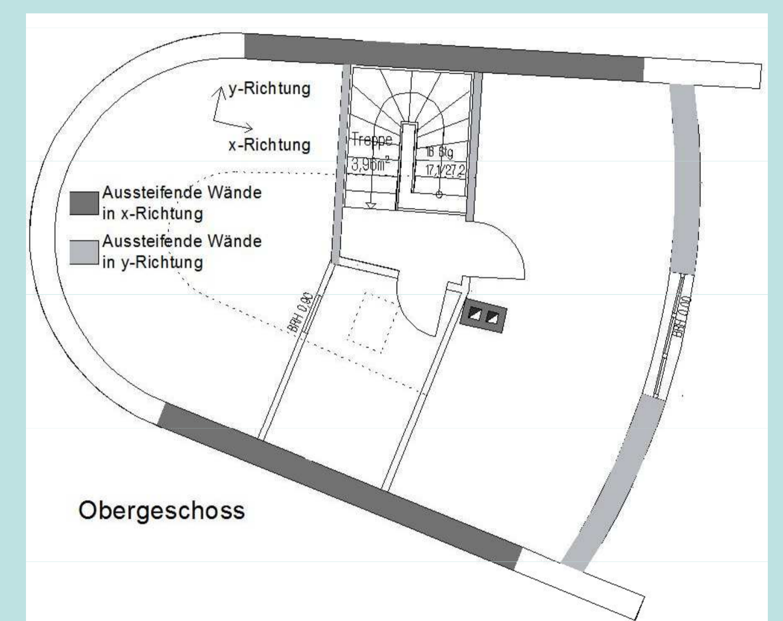
Beispielgebäude Obergeschoss Gebäudeaussteifung
